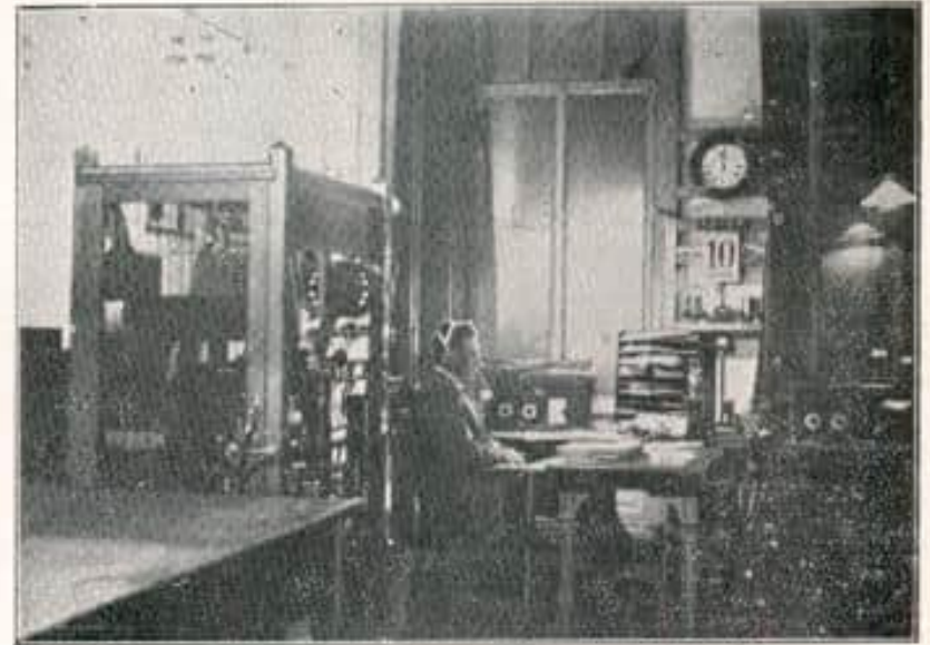
Tonic-train zender en ontvanginrichting voor 600 Meter te IJmuiden (Pch.).
