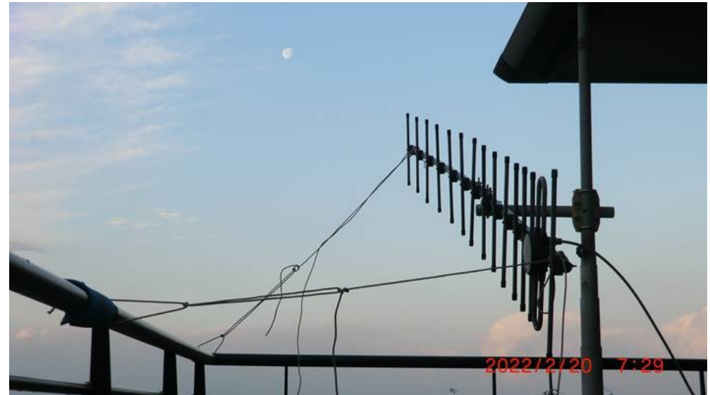
432MHz EME vanaf het balkon! JF2AIA met 15el. and 30W
