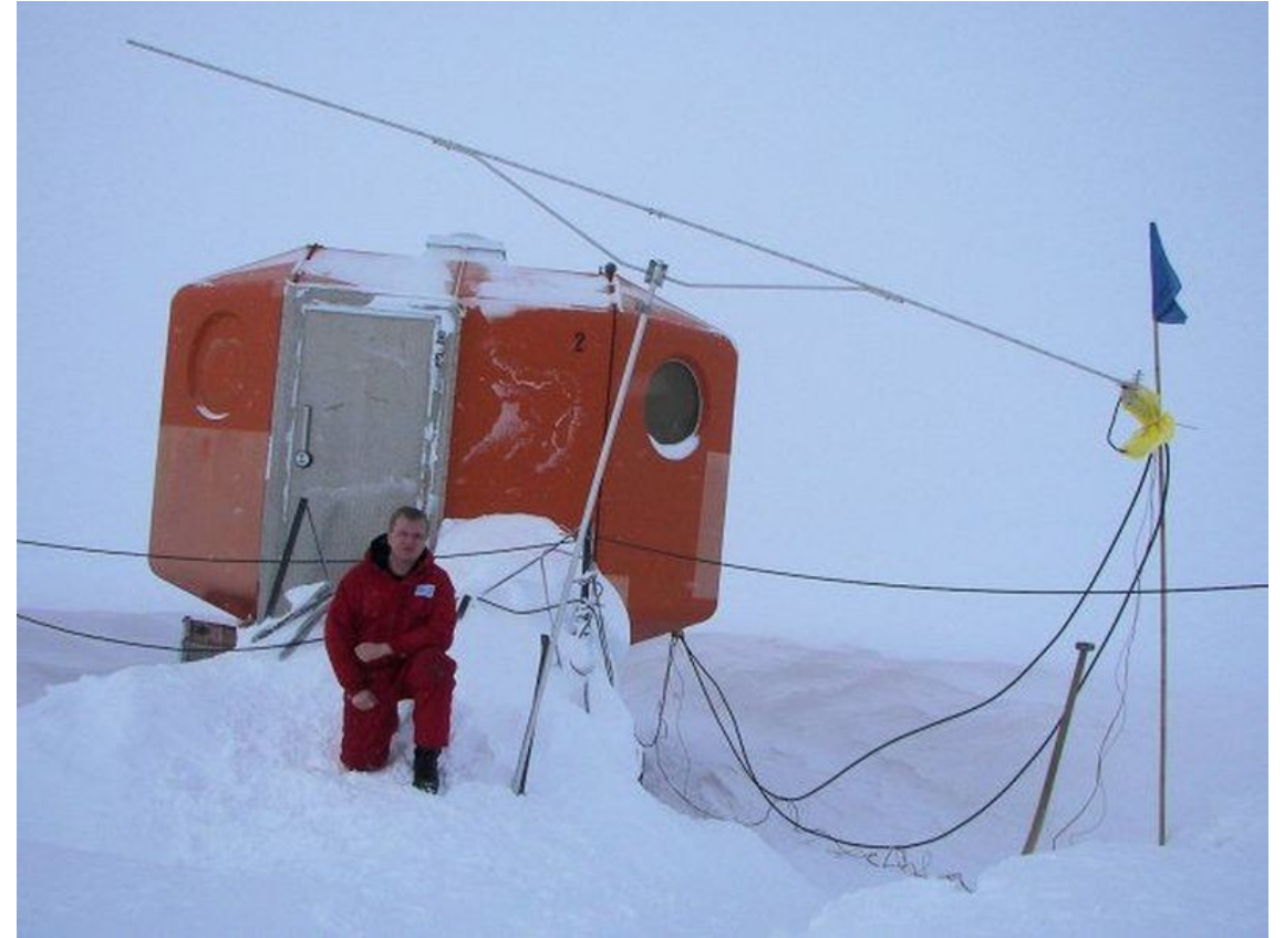
1296MHz DP1POL Zuidpool 67el yagi – 400W
