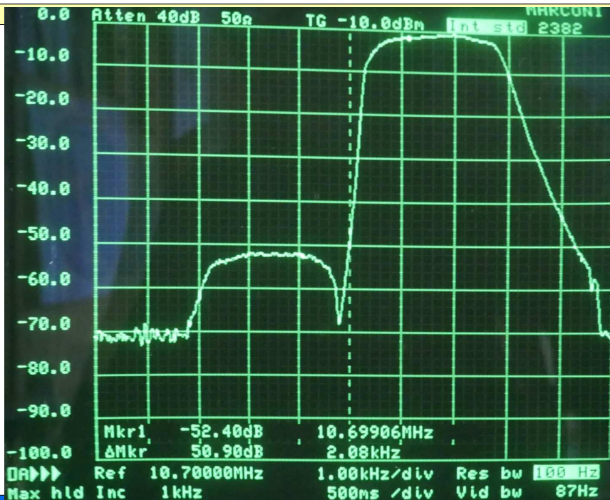
19 Zijband onderdrukking LSB na ruim 2 jaar na afregeling: ca. 52 dB.
