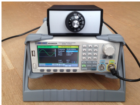
Bild 10: SDG6022X mit einem zusätzlichen, stellbaren Dämpfungsglied 0-70dB
