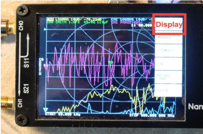
Wir lassen den LOAD - Widerstand auf dem TX - Port und tippen mit dem Finger oder einem „Stimulus“ auf den Bildschirm („**Stimulus**“ = offizieller Stift mit Gummikappe oder ein Bleistift mit aufgesetztem kleinen Radiergummi). Dadurch öffnet sich das Haupt-Bedienermenü am rechten Bildschirmrand und darin müssen wir weiter machen.
