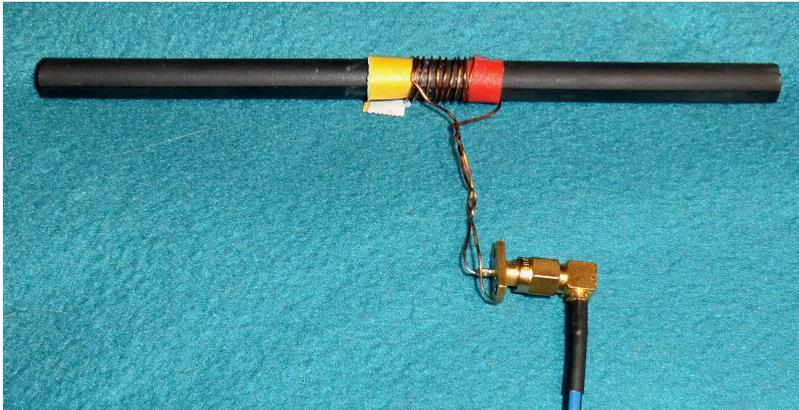
Zuerst werden die alten, vorhandenen Wicklungen entfernt und dafür **10 Windungen Kupferlackdraht CuL mit 0,5 mm Durchmesser** aufgebracht. Die Enden dieser Spule werden an eine **SMA-Buchse gelötet** und die wird mit den Messkabeln des NanoVNA verbunden.
