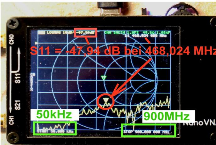
Drücken wir nun den **Multifunktionsschalter MFS** nach rechts und halten ihn dort fest, dann wandert der Marker vom Start bei 50 kHz zu höheren Frequenzen. Da versuchen wir mal,  $f = 468 \text{ MHz}$  zu erwischen und lesen dann ab (...genau sind es 468,042 MHz). Auf der Skala am linken Diagramm-Rand finden wir eine 10 dB – Teilung sowie oben den „Null dB – Punkt“.
