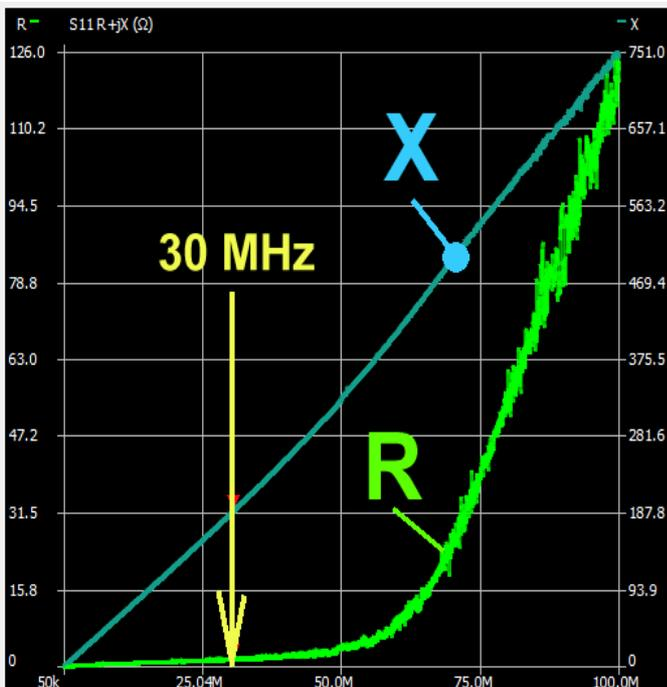
Man sieht am Kurvenverlauf, dass etwa ab **50 MHz die Induktivität größer** wird (= X - Kurve wird steiler).
